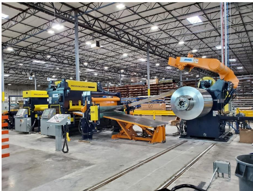
ANDRITZ Herr-Voss Stamco Precision Leveler®
